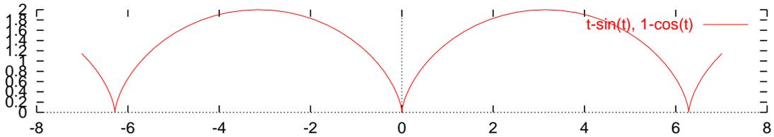
図 10: サイクロイド  $(x, y) = (t - \sin t, 1 - \cos t)$  (gnuplot による)
